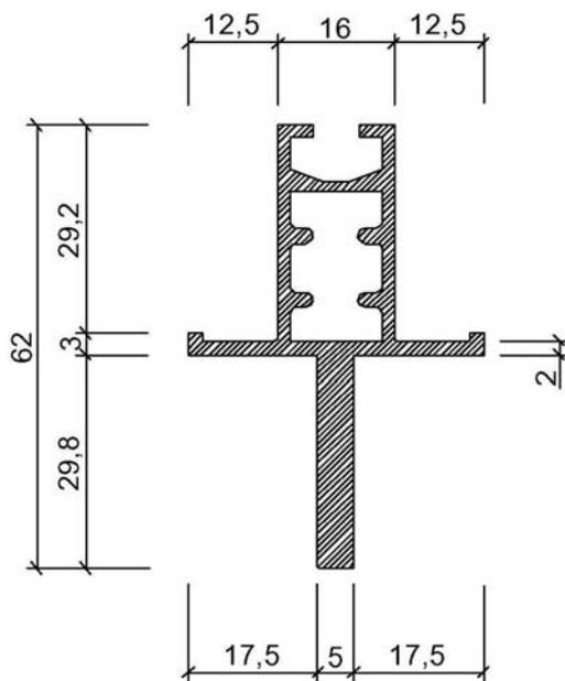
Die Strangpressprofile der Lichtdeckenbaureihe 200 haben eine Ansichtsbreite von 40mm und können in fast allen RAL Farben oder in E6EV1 eloxiert gefertigt und geliefert werden.
